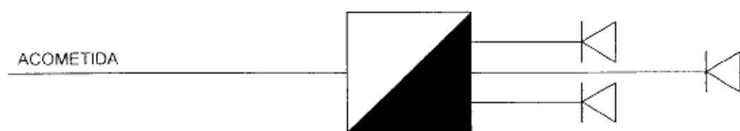
Figura 2 - Sistema de distribución directa
